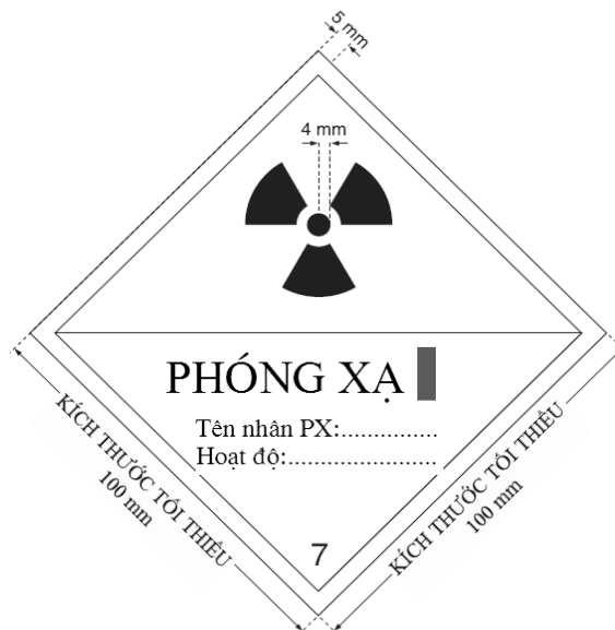
Hình 2. Nhãn I-TRẮNG: nền màu trắng, dấu hiệu cảnh báo bức xạ màu đen, chữ màu đen, chữ I màu đỏ, kích thước mỗi chiều tối thiểu 100 (mm).
